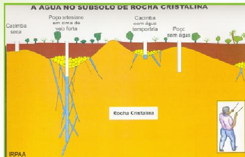
O desenho ao lado mostra a água que é armazenada no semiárido em subsolo de rocha cristalina. Nele podemos ver cacinba seca, poço artesiano furado em cima de um veio forte de água, cacinba com água temporária e poço seco.
