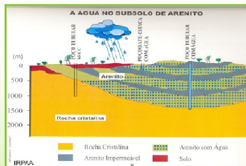
A figura ao lado mostra a água que pode ser armazenada e encontrada no subsolo de arenito. Como podemos ver, nestas regiões há possibilidade de ter poços secos, poços rasos bate-estaca e poços tubulares mais profundos e com muita água.
